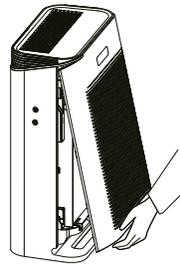
Bringen Sie die Filterabdeckung wieder an und schließen Sie ihn an die Stromquelle an.
