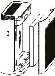
Setzen Sie den Filter mit dem kleinen Griff nach außen wieder in den Luftreiniger ein.
