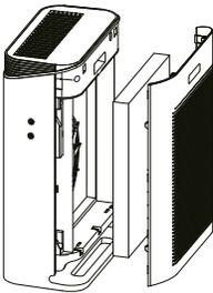
Помістіть фільтр назад в очищувач так, щоб його ліва ручка була спрямована назовні.
