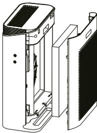
Așezați filtrul înapoi în purificator cu mânerul mic îndreptat spre exterior.
