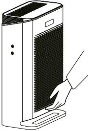
Retire la cubierta del filtro tirando del asa inferior
