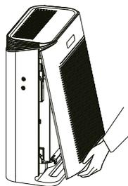
Vraťte víko filtru zpět na místo a zapojte přístroj do elektrické sítě.
