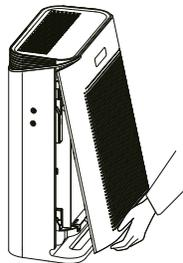
Remettez le couvercle du filtre en place et branchez l'appareil à la source d'alimentation.
